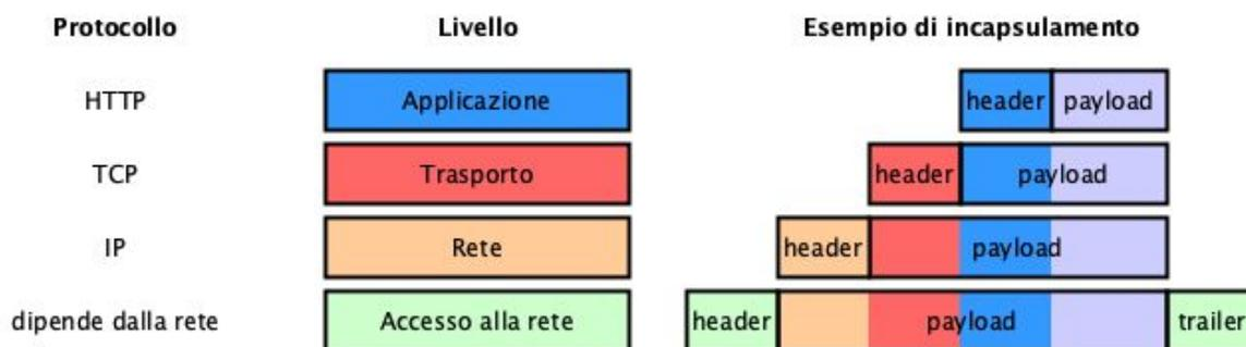
**Figura 6.** I quattro strati di incapsulamento, i relativi protocolli per scambiare dati su Internet, e un esempio grafico di come i vari messaggi vengono incapsulati. Nei pacchetti dello strato più in basso, quello di accesso alla rete, solitamente, oltre all'*header*, compare anche un piccolo pezzettino chiamato *trailer*, che determina la fine del pacchetto.
