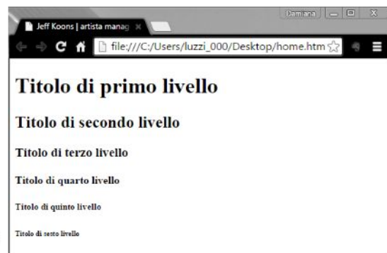
Figura 6. Gli elementi usati per definire i titoli del contenuto di un documento HTML, e come sono visualizzati sul browser.
